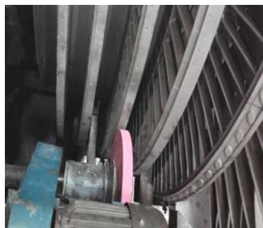
图 10 低压转子围带修磨
