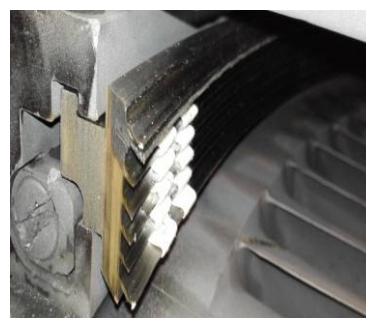
图5 密集低齿刷式汽封
