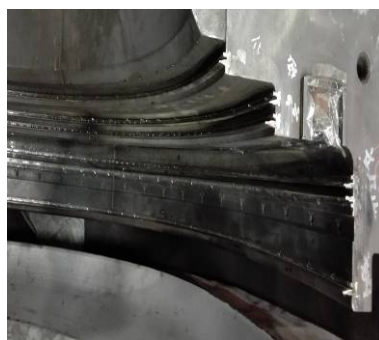
图1 高压缸调节级喷嘴阻汽片
