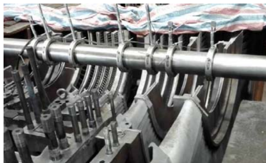
图 9 半实缸变形量测量
