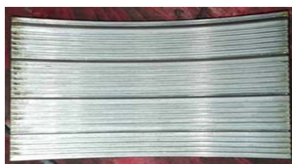
图2 密集低齿梳齿汽封
