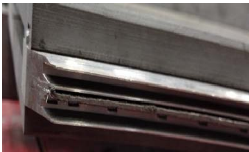
图 6 刷式汽封(增加一道梳齿)
