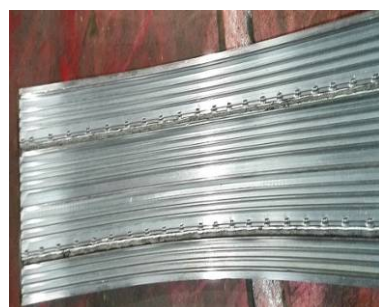
图3 密集低齿刷式汽封
